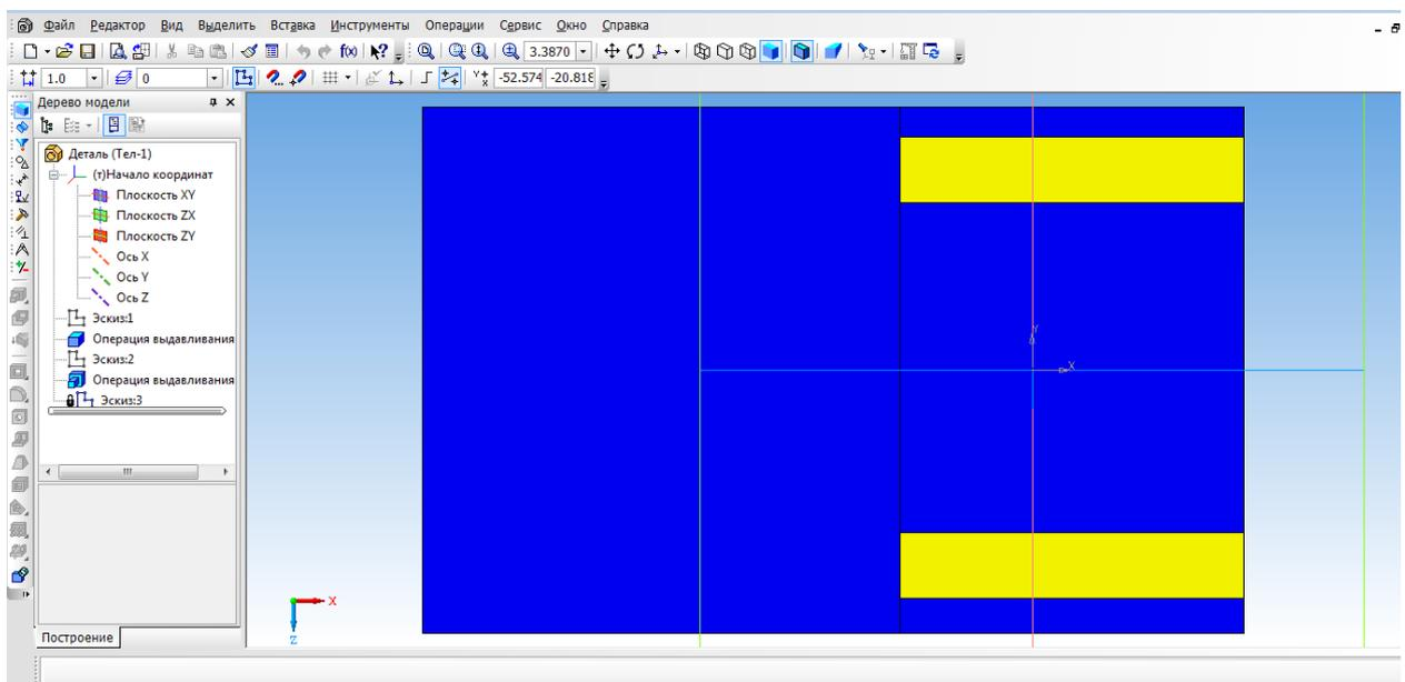
14. Выбрать прямоугольник типа: по центру и вершине. С помощью выравнивания осуществляем привязку к центру координат и середине стенки. Строим прямоугольник на всю ширину верхней грани. Закрываем эскиз.
