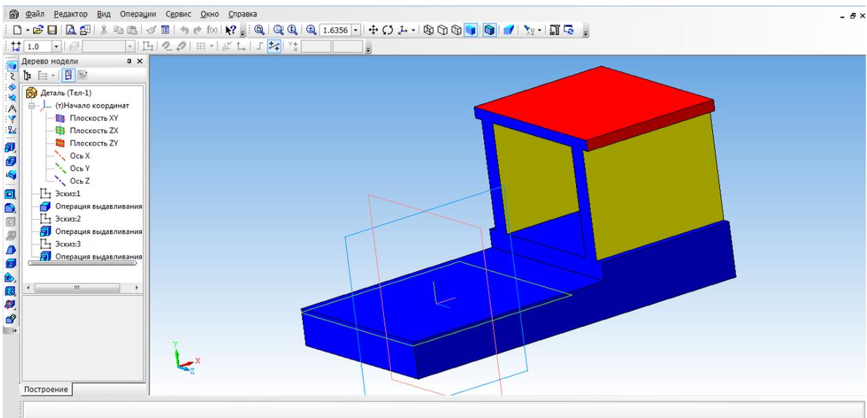
16. Создаем топливный бак. Выбрать грань кабины. Для начала необходимо создать проекцию. Выбрать инструмент **Спроецировать объект** и создать проекцию ребра.
