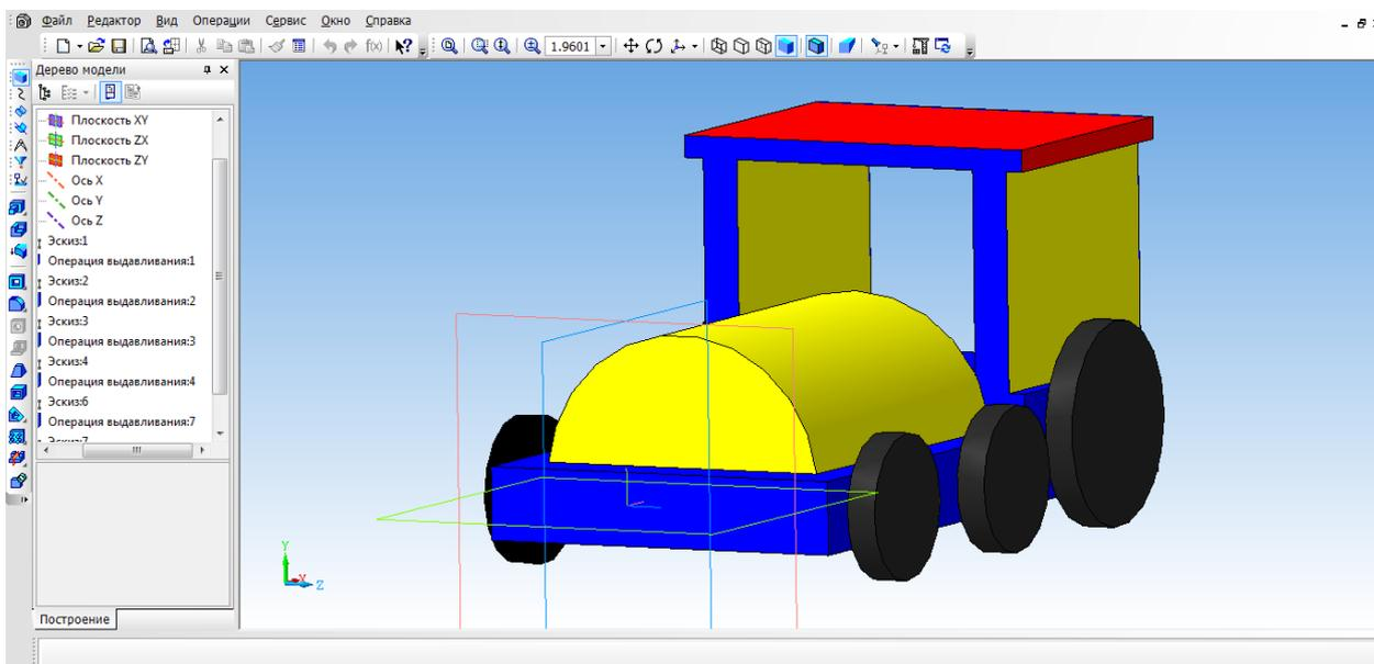
26. Создаем имитацию колеса. Выбираем грань одну из колес, переходим в режим **Эскиз**.
