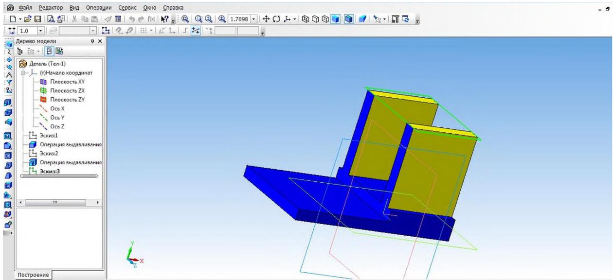
15. Выбрать операцию выдавливание (параметры: прямое направление, на расстоянии 3 мм, на вкладке свойства выбрать цвет крыши)
