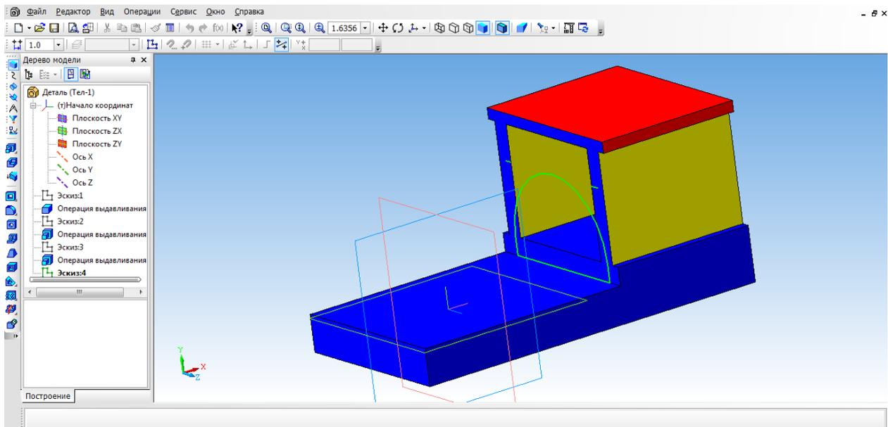
20. С помощью **Операции выдавливание** (параметры: прямое направление, на расстоянии 55 мм).
